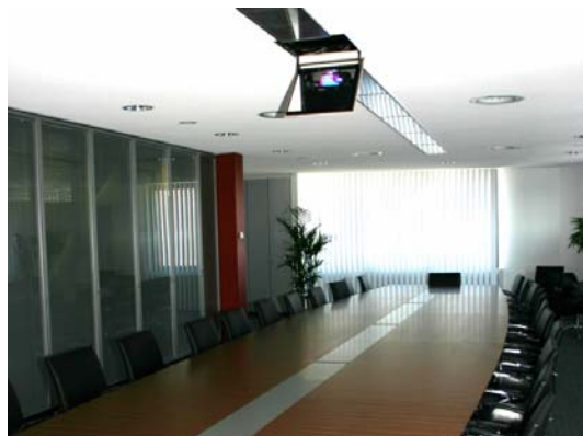
Konferenzraum mit ausgeklapptem, deckenbündigem Spiegel für die Beamerprojektion
